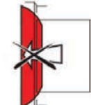
Nebezpečí zranění a věcných škod přitisknutím křídla proti okraji otvoru
